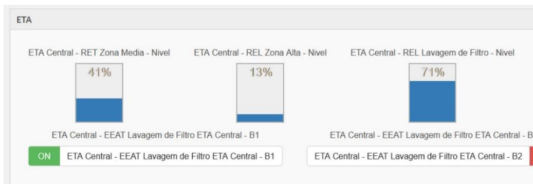
Imagem 15 – ETA Central: RET Zona média – 41%, REL Zona Alta – 13%, REL Lavagem de filtro – 71%. Fonte – Site: https://www.saneago.com.br/automacao/dashboard , Supervisório Saneago, 14/10/2023 às 18 horas.
