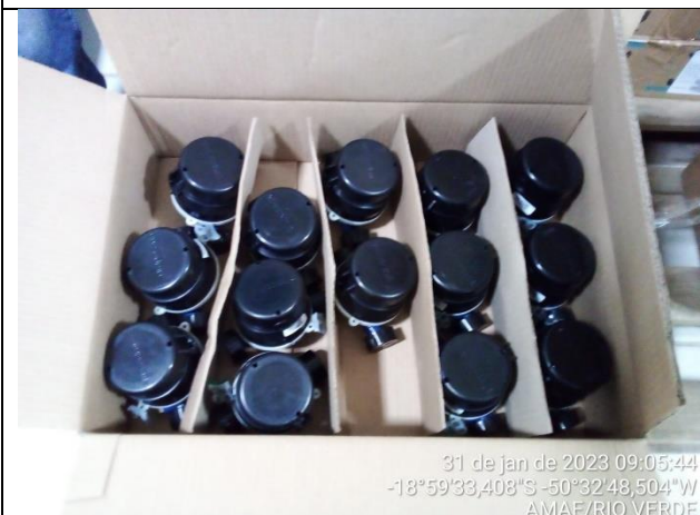
Autor: AMAE Descrição: Equipe da AMAE realizando a conferência de hidrômetros novos a serem instalados.
