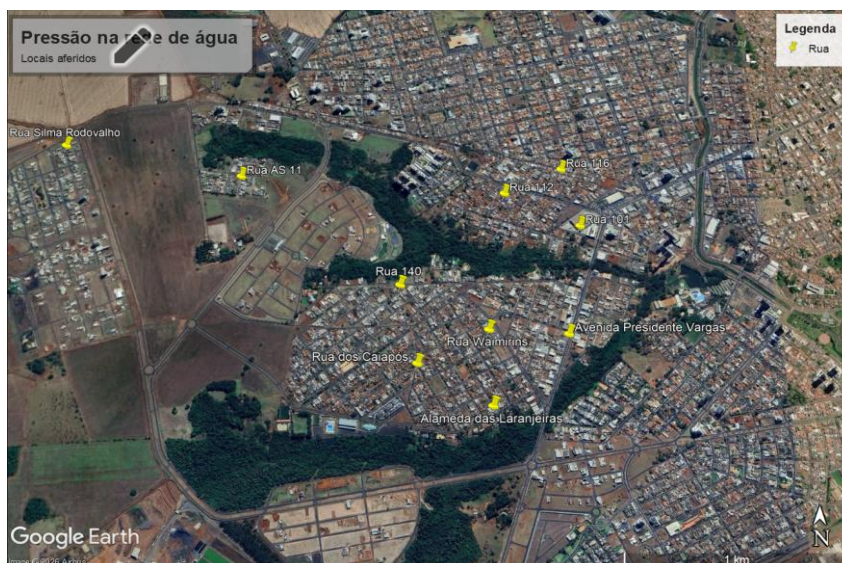
Figura 1: Identificação dos pontos onde foram realizadas as aferições de pressão nos cavaletes de entrada de água tratada. Fonte: Google Earth (2026).
