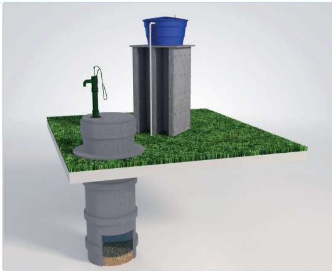
FIGURA 5 – ESQUEMATIZAÇÃO DE UM MINI POÇO.
