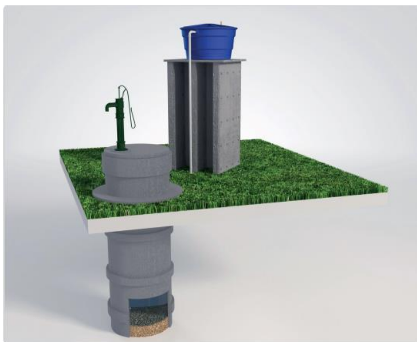
FIGURA 119 – ESQUEMATIZAÇÃO DE UM MINI POÇO.
