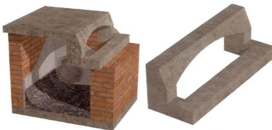
IMAGEM 22: Boca-de-lobo em concreto armado e caixa de inspeção (fonte: Caderno de Encargos DEP-Porto Alegre/RS).
