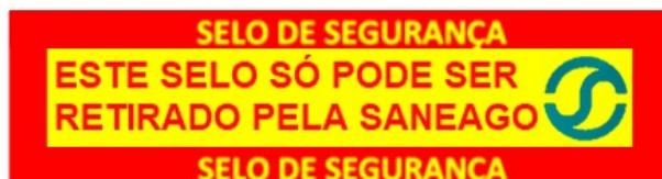
Figura E.1: Selo de segurança para aplicação sobre o parafuso que fixa a tampa do compartimento da Saneago
